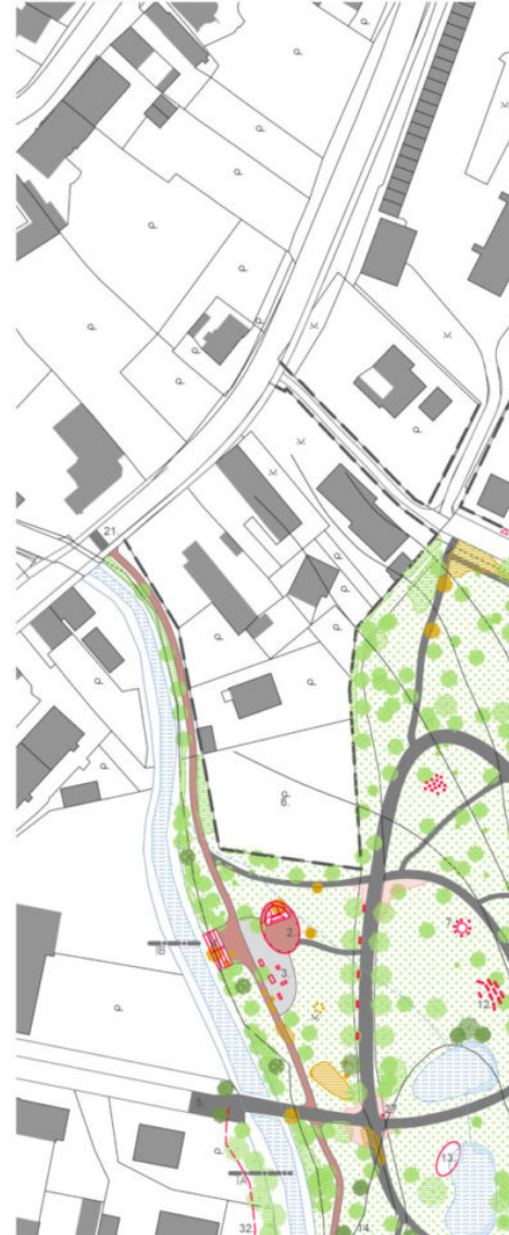
DETAIL VEDENÍ CESTY PODĚL POTOKA A DOPLNĚNÍ PŘECHODU PRO CHODCE V ULICI LEGIONÁŘSKÁ
